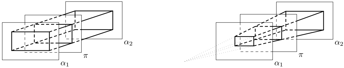
OBR. 1. Viditeľný objem pri rovnobežnom a stredovom premietaní: \pi – priemetňa, \alpha_1 – predná orezávací rovina, \alpha_2 – zadná orezávací rovina
