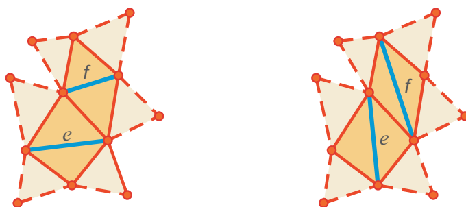
Obr. 3.11: Hrany e a f pred (vľavo) a po (vpravo) paralelnom preklápaní hrán. V prípade hrany e , hrana f by nemala byť preklápaná, platí to aj opačne.
