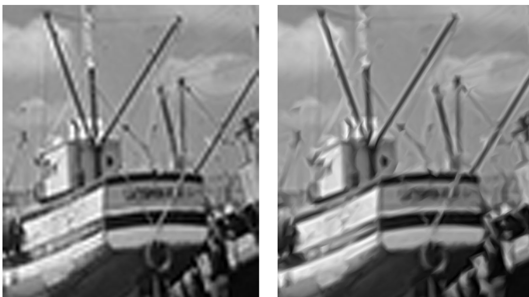
Obr. 2.9: 600% magnifikácia pomocou konvulčnej techniky (vľavo) a geometricky založenej techniky (vpravo).
