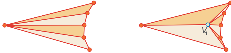
Obr. 2.10: MWT triangulácia pôvodnej množiny na ľavej strane. Na pravej strane, pridaný vrchol V_1 , cena MWT tejto množiny je nižšia.
