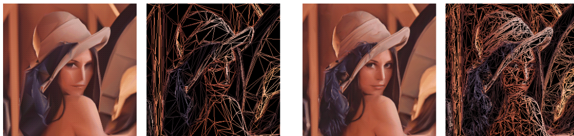
Obr. 2.26: Aproximácia obrázku pomocou 800 vrcholov (ľavá strana) a pomocou 3200 vrcholov (pravá strana). Pôvodný obrázok mal rozlíšenie 256 \times 256 pixlov. Zdroj obrázku [Kre].
