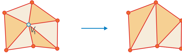
Obr. 2.7: Aplikácia topologickej operácie odstránenie vrchola na vrchol V_1 .
