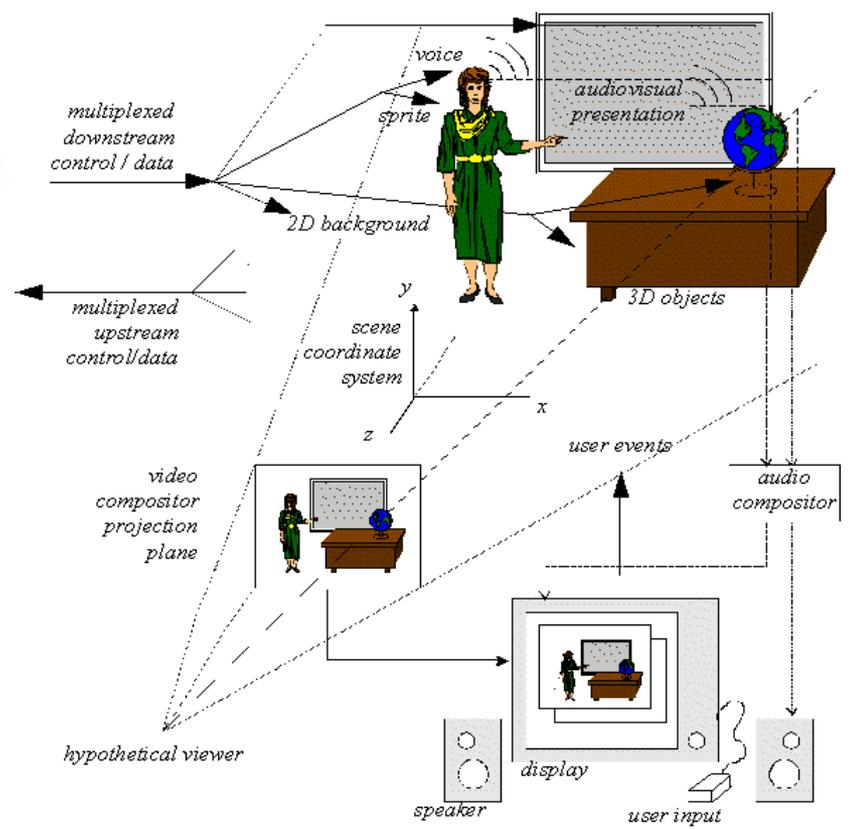
Obr. 20.1 Architektúra multimediálneho systému
